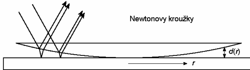
Obr. DI-5. Uspořádání pro pozorování Newtonových kroužků v odraženém světle.
