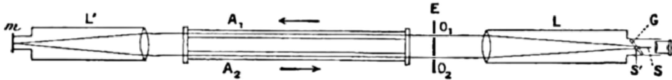
Výsledek měření (z posunu interferenčního obrazce) souhlasil s Fresnelovou teorií částečného strhávání éteru.
