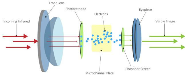
Obr. 3: Schéma noktovizoru.
