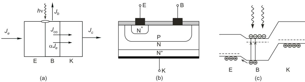
Obr. 26: Fototransistor a) náhradní schéma b) schéma provedení c) pásové schéma.
