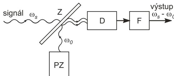
Obr. 12: Schéma heterodynnej detekce. Detektorem je fotoodpor nebo fotodioda, na který dopadá také signál z pomocného zdroje (laser, LED). Z je polopropustné zrcadlo a F je filtr, který propouští pouze signál s rozdílovou frekvencí.
