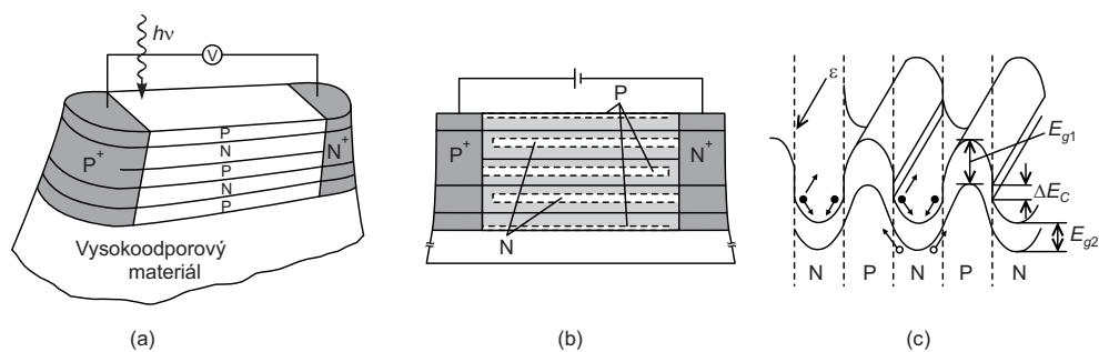
Obr. 29: Kanálová lavinová fotodioda a) schéma provedení b) průřez diodou c) pásové schéma. F. Capasso, IEEE Transaction on electron devices, ED-29(9), 1982, 1388-1395.
