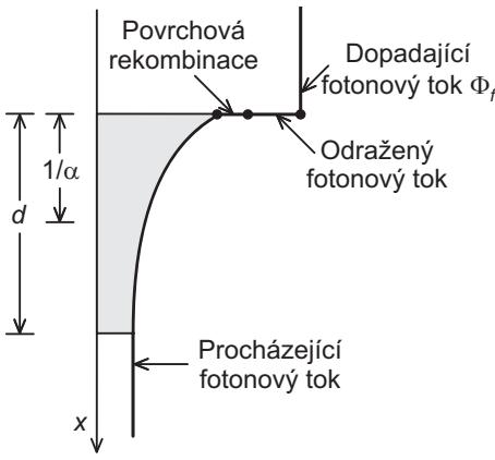
Obr. 7: Kvantová účinnost detektora.
