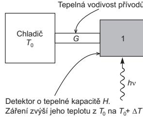
Obr. 11: Schéma tepelného detektoru.
