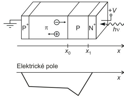
Obr. 20: Lavinová fotodioda (APD) - elektrické schéma
