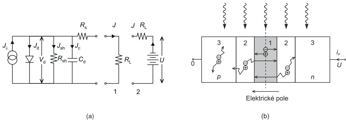
Obr. 16: a) Náhradní schéma fotodiody: a1) fotovoltaický PV režim, a2) fotovodivostní PC režim.  $J_\lambda$  - proud generovaný signálem,  $R_{sh}$  - paralelní odpor,  $R_S$  - sériový odpor,  $C_d$  - paralelní kapacita,  $R_L$  - pracovní odpor; b) schéma fotodiody.
