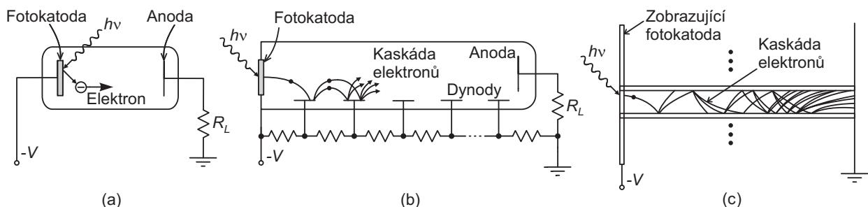
Obr. 2: a) Fotonka, b) Fotonásobič, c) Mikrokanálový detektor.
