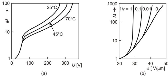
Obr. 22: Závislost zesílení v APD a) na závěrném napětí při různých teplotách b) na elektrickém poli pro různý ionizační poměr.
