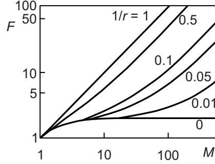
Obr. 24: Závislost šumového faktoru  $F$  na koeficientu zesílení  $M$ . Parametr  $r$  je ionizační poměr.
