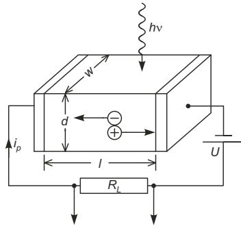
Obr. 13: Schéma fotooodporu
