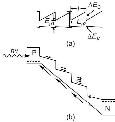
Obr. 28: Pásové schéma supermřížky GaAlAs/GaAs,  $\Delta E_c = 0,48\text{eV}$ ,  $\Delta E_v = 0,08\text{eV}$ .
