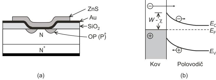
Obr. 25: Schottkyho dioda Au-Si s ochraným prstencem (OP).
