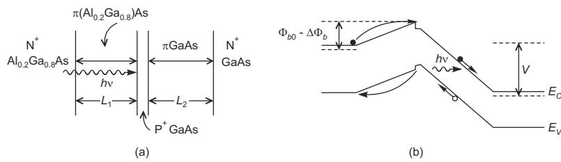
Obr. 19: PIN fotodioda s modulovanou bariérou a) struktura b) pásové energetické schéma
