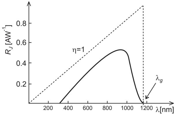
Obr. 17: Proudová citlivost fotodiody
