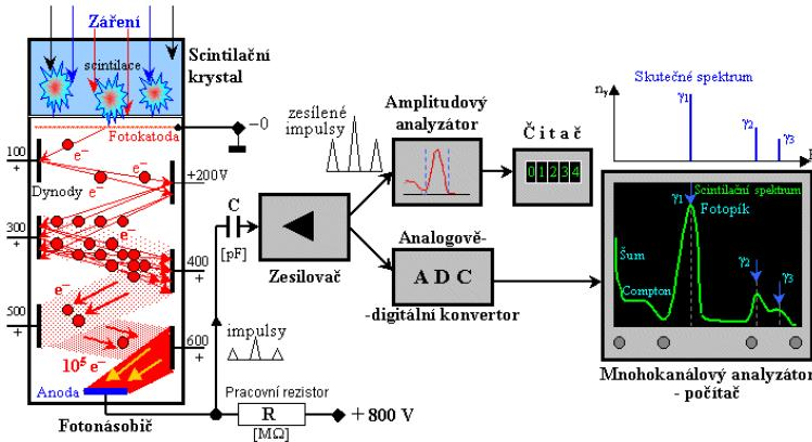
Obr. 6: Schéma scintilátoru.
