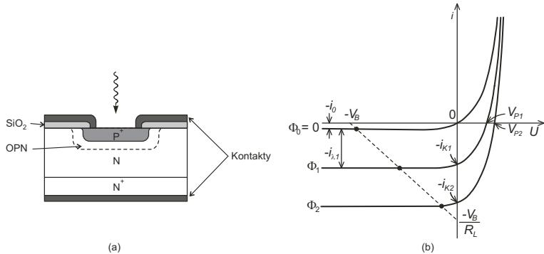
Obr. 15: Fotodioda a) Si fotodioda b) V-A charakteristika fotodiody
