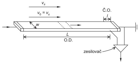
Obr. 32: Detektor SPRITE (O.D.-oblast driftu, Č.O.-čtecí oblast.)
