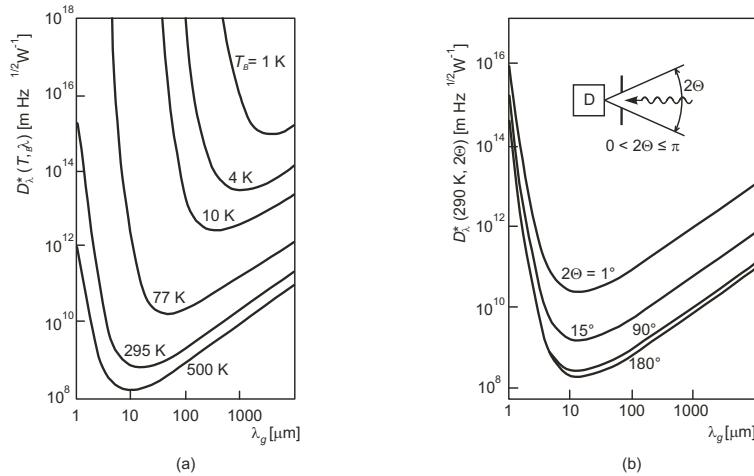
Obr. 10: Měrná detektivita v závislosti na dlouhovlnné meze detektoru; a) Prostorový zorný úhel  $2\theta = \pi$ , parametrem je teplota okolí  $T_B (\text{K})$  b) Teplota okolí  $T_B = 290 \text{ K}$ , parametrem je prostorový zorný úhel  $2\theta$ .
