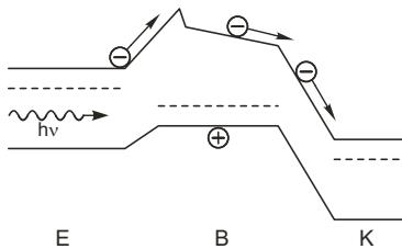
Obr. 27: Fototransistor s gradovanou bazí.
