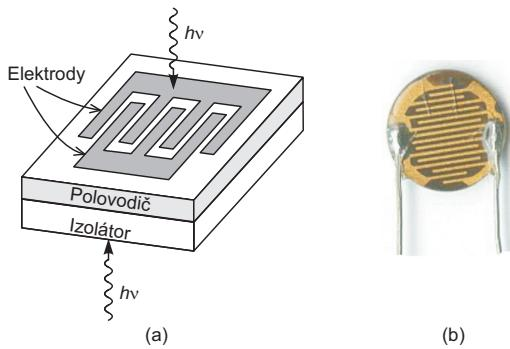
Obr. 14: Fotoodpor a) schéma provedení b) CdS fotoodpor
