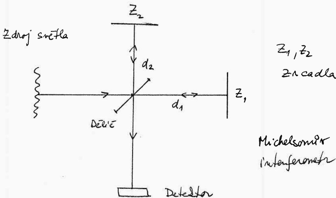
Při průchodu interferometrem vzniká dráhový rozdíl  $2(d_1 - d_2)$ . Ten je řídicím parametrem pro vznik interference. V prostoru detektoru vzniká při IF vlna s intenzitou  $I = 4I_0 \cos^2 \frac{\delta}{2}$ . To vyplývá
