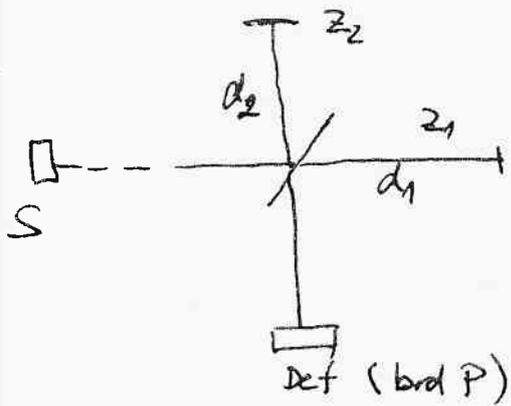
V detektorovém prostoru interferují paprsky s dráhovou rozdílem  $\Delta l = 2(d_2 - d_1)$
