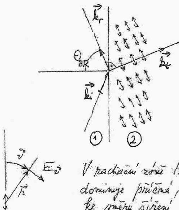
V radiaci zóně Hertrova dipolu dominuje příčné ploška vzhledem ke směru píření
