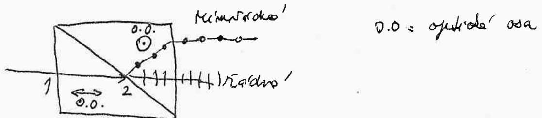
V bodě 1 dopadá vlna na dvojčermný materiál (jednoosý). Při šíření podél optické osy se obě vlny lineárně polarizace šíří stejnou rychlostí  $\rightarrow$  nedochází k lomu a vlna dospeje nezměněna k bodu 2. Zde je optická osa v rovině rozhraní, takže se rovinně dopadne. Jelikož je přechod o rozhraní dvou stejných materiálů, takže vlna se neláme a šíří se s indexem  $n_o$  (je polarizována  $\perp$  na optickou osu). (tj. na rovinu hranice není danou  $\vec{s}_o \parallel \text{O.O.}$ )
