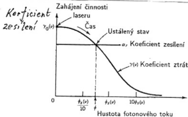
Obrázek 14.2-1 Určení stacionární hustoty fotonového toku \phi . V okamžiku zahájení funkce laseru je \phi = 0 , takže \gamma(\nu) = \gamma_0(\nu) . Jak oscilace v čase vzrůstají, rostoucí \phi způsobuje následkem saturace zesílení pokles \gamma(\nu) . Když \gamma dosáhne \alpha_r , hustota fotonového toku se přestane zvyšovat a je dosaženo stacionárních podmínek. Čím menší jsou ztráty, tím větší je hodnota \phi .
