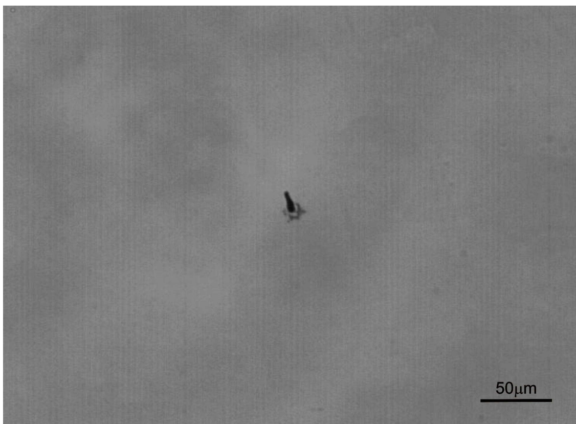
Snímka 9.7b: Snímka kadmiovej inklúzie po žiňaní v parách telúru pri teplote 600°C po dobu 20 hodín, teplota v najchladnejšom mieste ampule bola 520°C. Z inklúzie zostalo iba jadro nesymetrického tvaru.
