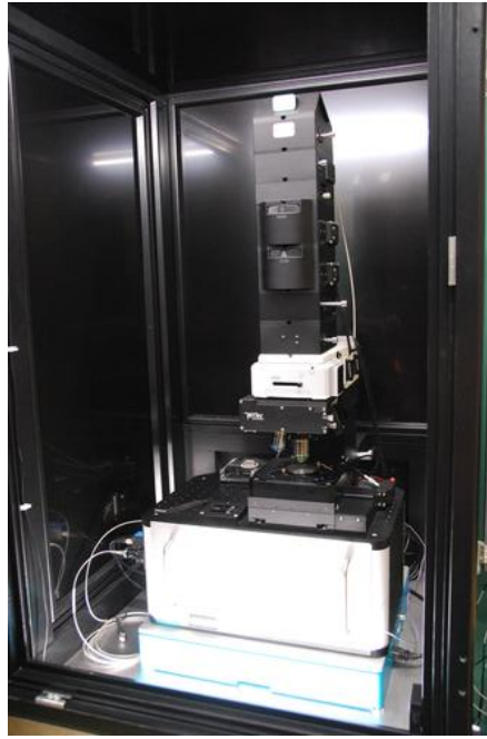
Obrázek 2.4: WITec Alpha 300RSA konfokální Ramanuv mikroskop.
